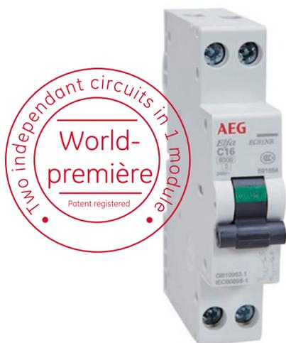
随着现代工业生产和居民生活对用电质量的要求日趋增高、终端用户更加接近电源变压器、生活电器日趋增多等因素，使得终端配电线路对配电箱体积、保护回路数量、产品可靠性、技术参数等将提出更高的要求 and 变革。EC90 紧凑型小型断路器采用先进的设计理念，稳定的制造工艺，全自动检测手段，其产品运行短路分断能力达到 6kA，2P 产品宽度仅 18mm，颠覆了传统 2P 产品 36mm 宽度的设计思维，能节约配电箱 50% 的空间，可完美解决当下终端用户的用电保护需求。
